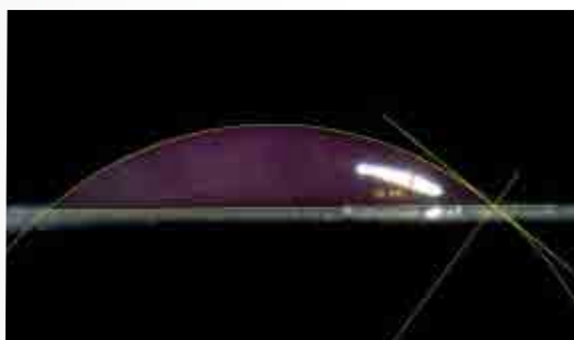
Confronto bagnabilità tra impianto trattato HSS e impianto sabbiato. Wettability comparison between HSS implant and sandblasted implant
